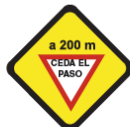
P 33(b) PROXIMIDAD DE SEÑAL RESTRICTIVA(paso)
